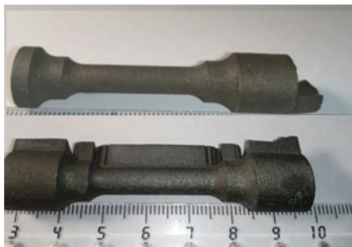
Рис. 1. Вид образцов, полученных методом СЛС
