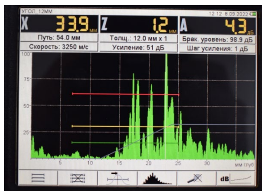
Рис. 1. а – Эскиз шлакового включения в сечении шва; б – Ультразвуковой контроль образца
