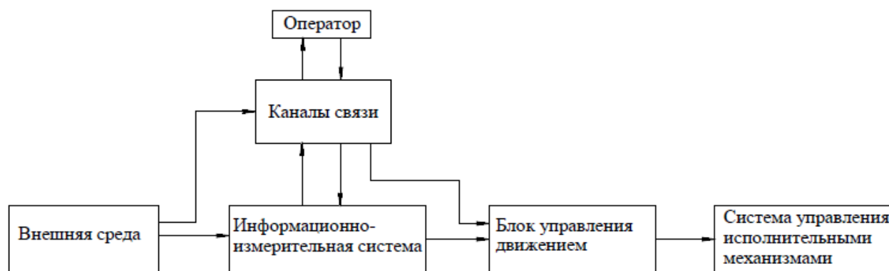
Рис. 6. Общий вид архитектуры системы управления
