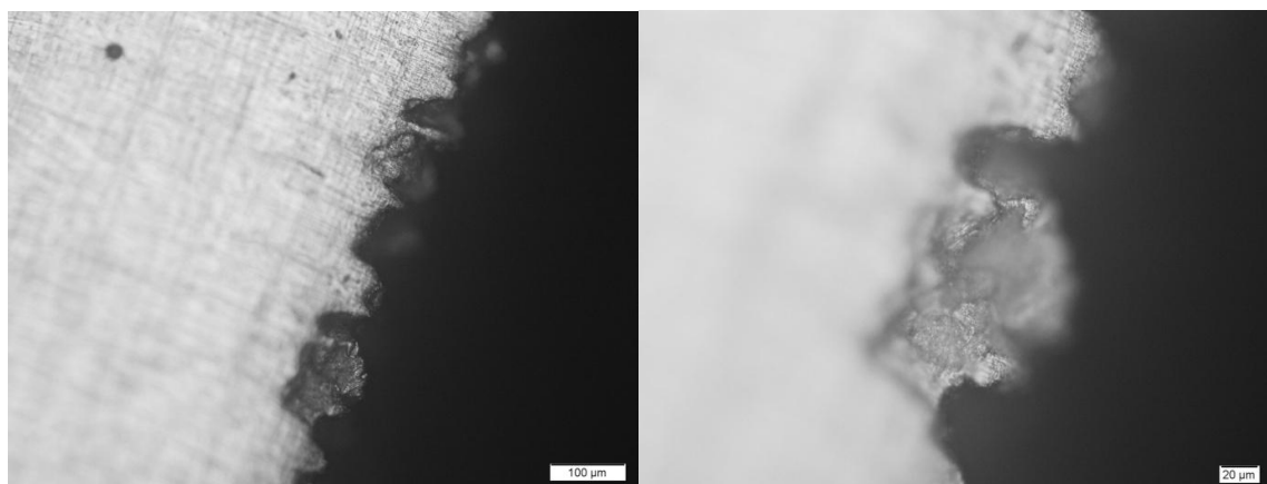
Рис. 6. Изображение среза сплава Zn-0,8%Li-0,1%Mg после коррозионных испытаний: a – образец № 1; б – образец №2
